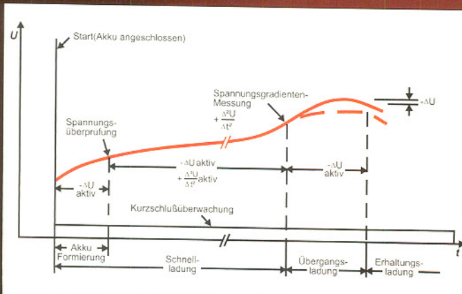
Akku-Spannungsverlauf beim Ladevorgang mit dem mikroprozessorgesteuerten innovativen Ladeverfahren von ELV
